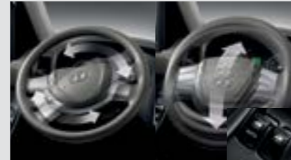
Vô-lăng trợ lực lái điện và có thể điều chỉnh lên-xuống.
